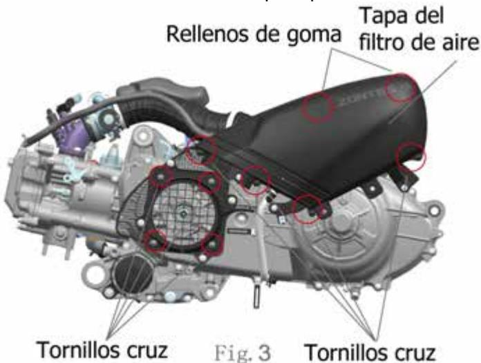
2. Como se muestra en la Figura 3, retire los 4 tornillos y retire la tapa de entrada de aire a la transmisión, luego retire el filtro de entrada de aire de la transmisión. Utilice una pistola de aire comprimido para eliminar el polvo del elemento del filtro de la transmisión desde el lado limpio (interior).
