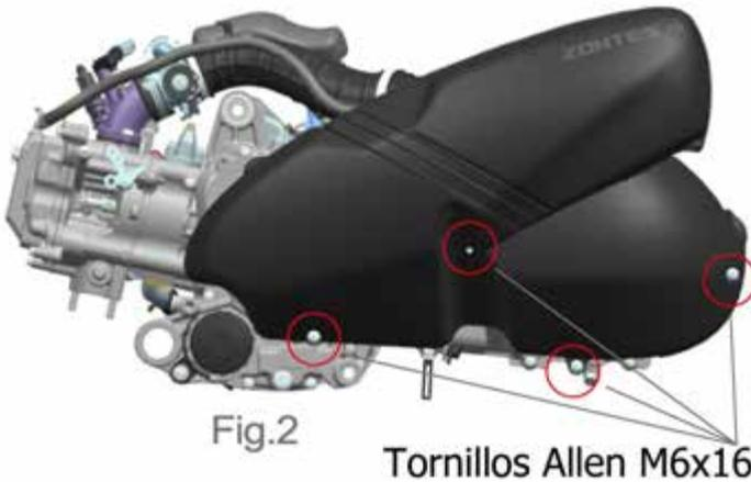
1. Como se muestra en la Figura 2, retire los 4 tornillos y retire la tapa izquierda de la transmisión (no hace falta retirar la cubierta decorativa posterior). Limpie la suciedad pegada a la esponja del filtro de la transmisión de la tapa izquierda
