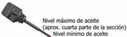
Para conseguir la máxima durabilidad del motor, es muy importante utilizar aceite motor de alta calidad y cambiar el aceite según se indica en la tabla de mantenimiento. Comprobar el nivel de aceite y cambiarlo periódicamente son dos importantes tareas del mantenimiento del vehículo.
