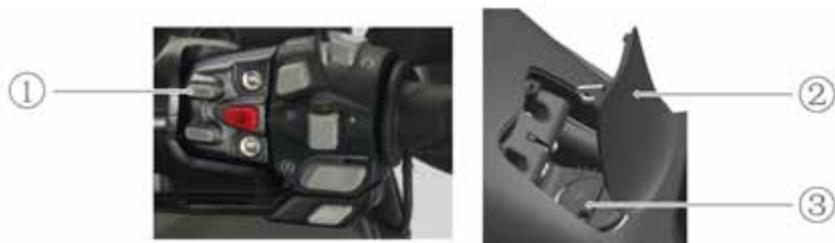
El depósito de gasolina se encuentra en el centro del vehículo. Cuando abra el tapón del depósito de gasolina deberá poner el interruptor cortacorrientes en OFF, pulse el botón de apertura del depósito de gasolina (1) y la tapa del depósito (2) se abrirá automáticamente; después gire el tapón del depósito (3) a la izquierda. Cuando vaya a cerrar la tapa después de repostar, ponga el tapón (3) sobre la boca de llenado y gírelo a la derecha.
