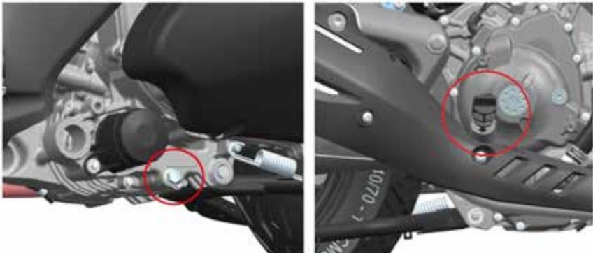
5. Monte el filtro de aceite, muelle, junta tórica y tapa del cartucho del filtro de aceite y apriételo al par especificado (par de apriete: 25 Nm).
