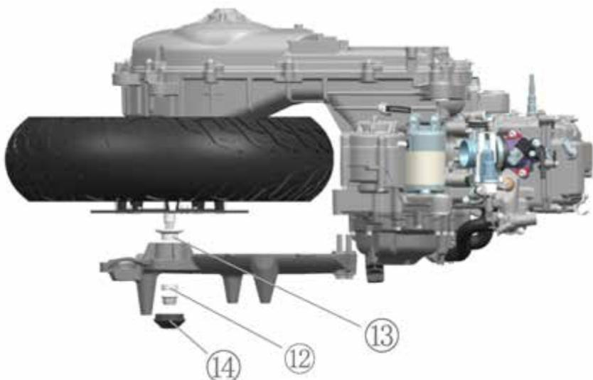
6. Afloje el latiguillo del disco trasero y retire la pinza. Retire la tuerca del eje trasero, saque el semibasculante y el guardabarros interior del filtro de aire y ya puede retirar la rueda trasera de su eje.
