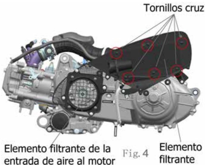
4. Como se muestra en la Figura 4, retire los 6 tornillos y saque el elemento filtrante del filtro de aire. Utilice una pistola de aire comprimido para eliminar el polvo del elemento del filtro de aire por el lado limpio (interior).
