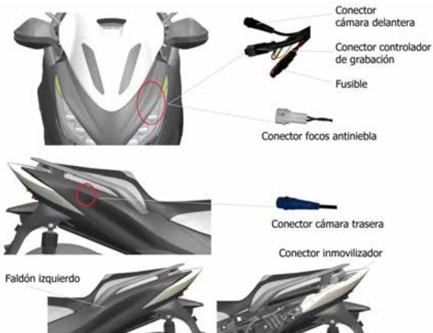
Este vehículo está preparado para recibir una serie de accesorios (grabador de conducción, luces auxiliares antiniebla,...) como muestra la figura superior. Estos componentes cuentan con conexiones impermeables.
